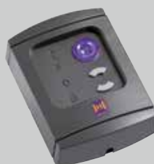
Bouton-poussoir IT 3b Grande touche rétroéclairée pour une ouverture confortable de la porte, deux touches supplémentaires pour la commande de la lampe de motorisation et la coupure de la commande sans fil, par exemple pendant les vacances (pour SupraMatic)
