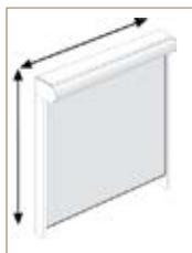
Coffre de 53 mm : largeur jusqu'à 1700 mm
